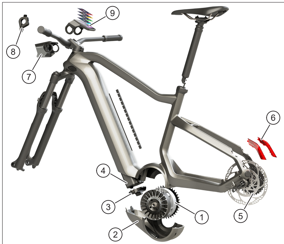
Ábra: 1: A FLYON-hajtásrendszer elemei
